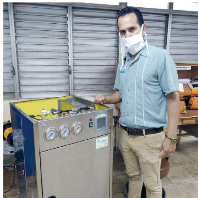
Luego de desinfectada, la planta de tratamiento de agua fue recuperada completamente en el taller del Centro Provincial de Electromedicina y, como acota Yosbel Tabares, se le hicieron pruebas simulando largas jornadas de trabajo para confirmar su eficiencia. | foto: De la autora
