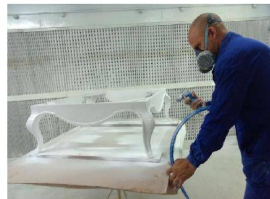
En el taller de acabado la nueva cabina de pintura está dotada de mecanismos que disminuyen la contaminación.
