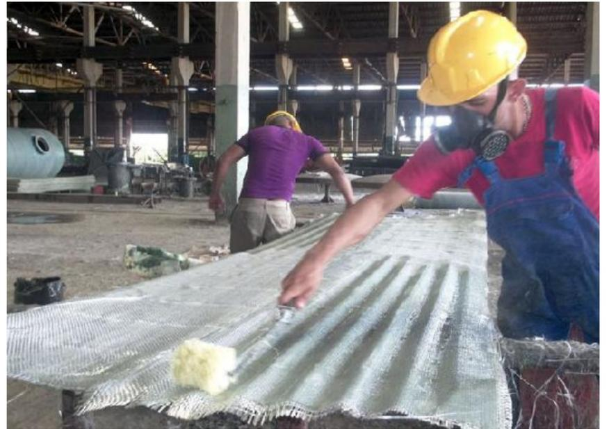
Tejas traslúcidas y conductos de plástico reforzado con fibras de vidrio fabrica el colectivo para todas las centrales termoeléctricas cubanas.
