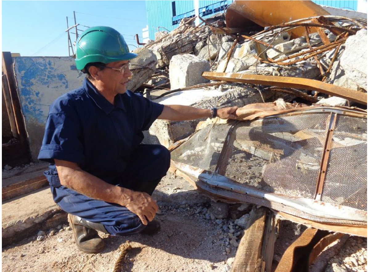
Román Pérez muestra una de las mallas averiadas, importante dispositivo de la casa de bombas de circulación.
