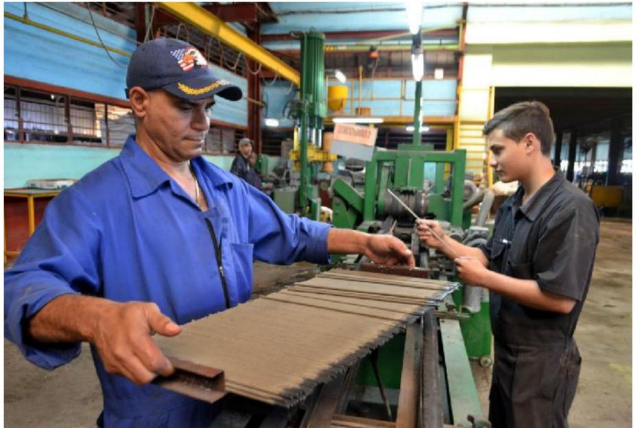
La empresa Cometal produce electrodos (varillas de soldar) de varios tipos: básicos, inoxidable, de hierro fundido y aluminio. | fotos: Eddy Martín
