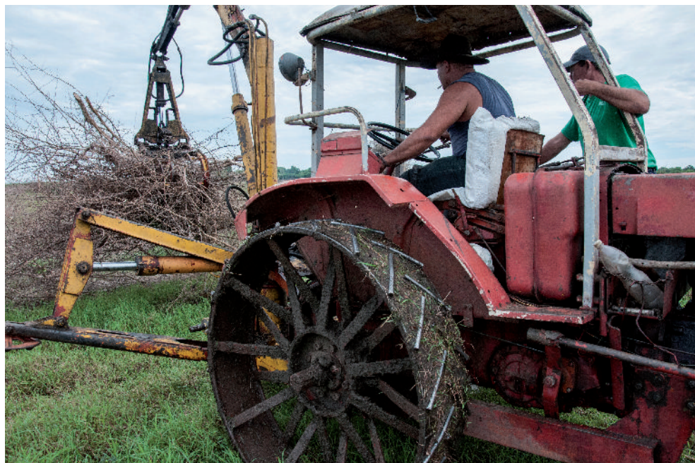
Con una alzadora, a la cual se le acoplan ruedas de hierro, se recoge el marabú para luego quemarlo.
