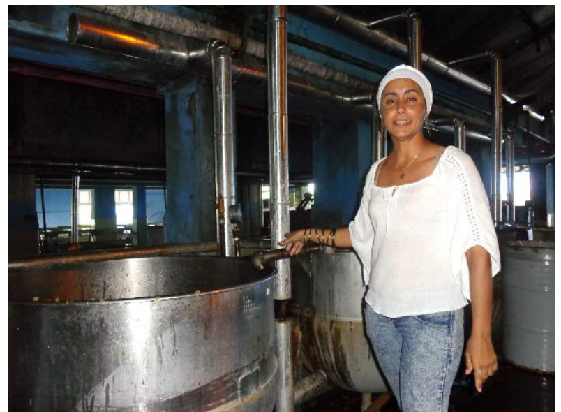
Katía Pérez Morejón, representante de la Anir en la UEB enseña una de las cocinas reparadas, con sus tuberías aisladas.
