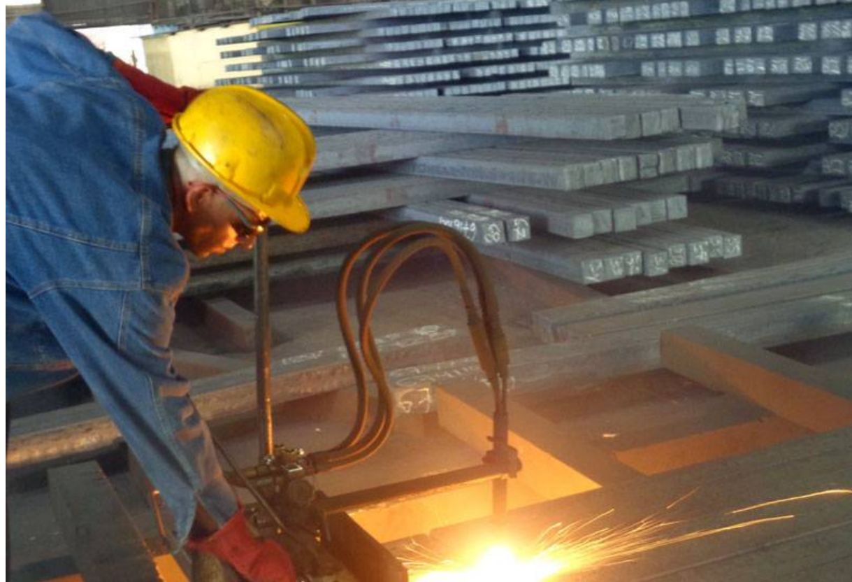
La reducción en un corte aporta ahorro de gas licuado y humaniza el trabajo.
