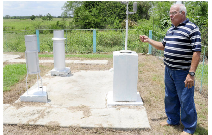
“El polígono cuenta con una derivadora, dos canales y una estación hidrometeorológica, donde se pueden medir todas las variables del ciclo hidrológico para realizar balances hídricos correctos”, comentó Eloy Alonso, especialista principal del grupo empresarial de Aprovechamiento Hidráulico del INRH. | fotos: Roberto Carlos Medina
