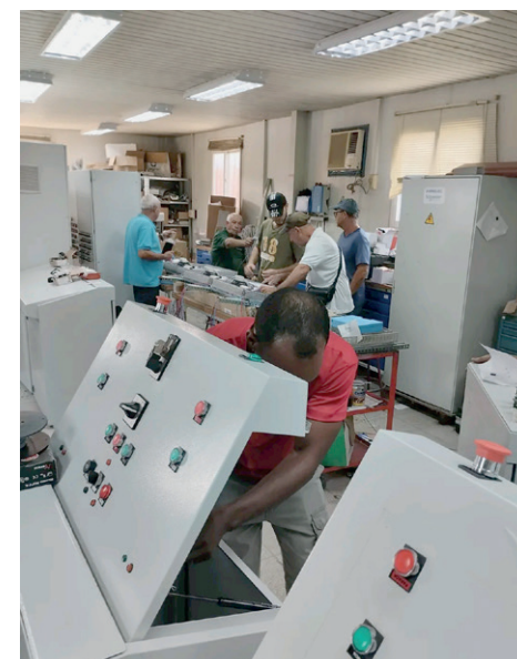
En el taller de Panelec se fabrican pizarras eléctricas para el sistema de Recursos Hidráulicos en todo el país. | fotos: Cortesía de Panelec
