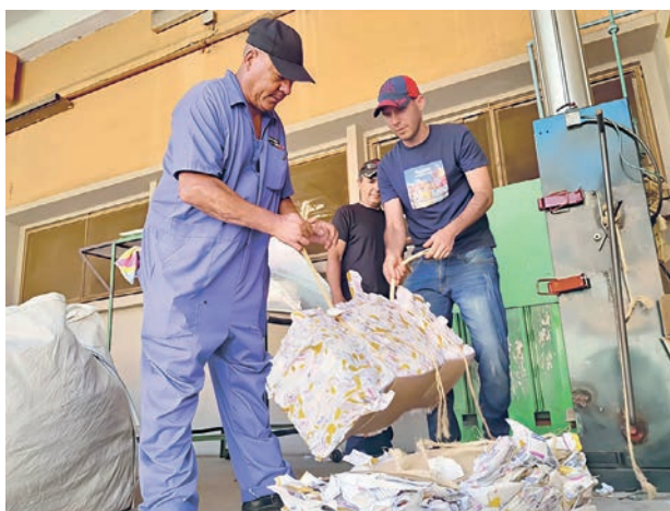
Entre los trabajos estimulados por alto desempeño figura una prensa compactadora de papel que no utiliza energía eléctrica y reduce los desechos de la industria. | foto: De la autora
