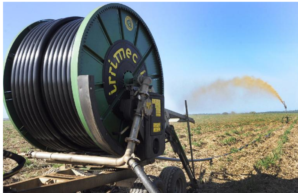
Las inversiones para el fertirriego con residuales azucareros son costosas, e incluyen carros cisterna y sistemas de enrolladores.
