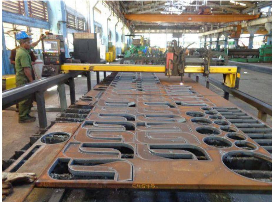
El pantógrafo de plasma permite cortar tres piezas a la vez con mayor rapidez y precisión.
